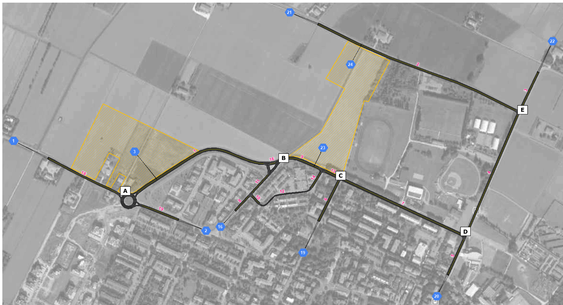
Figura 13-Schematizzazione con microsimulatore del grafo di rete considerato (scenario attuale)
